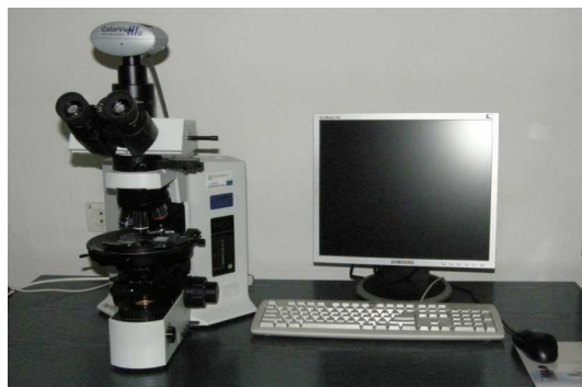
Fot. 4. Mikroskop BX-51 firmy Olympus do światła przechodzącego z polaryzacją, kontrastem fazy, kamerą cyfrową i programem do archiwizacji, wizualizacji danych
